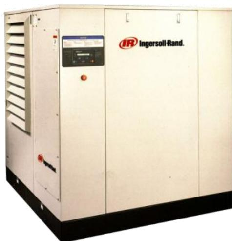
Compresor de aire tipo tornillos lubricados con refrigerante sintético Ultracoolant y transmisión de potencia mediante correas y poleas en V.
